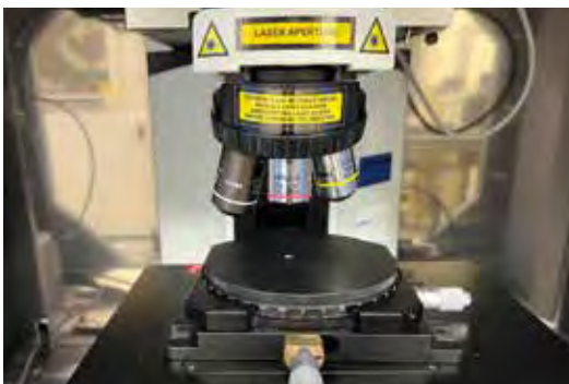
試料の非破壊・非接触測定ができる「顕微ラマン装置」
